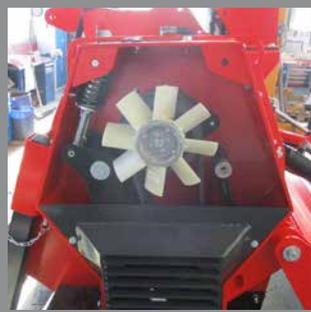
Refroidissement de la transmission par courroie
