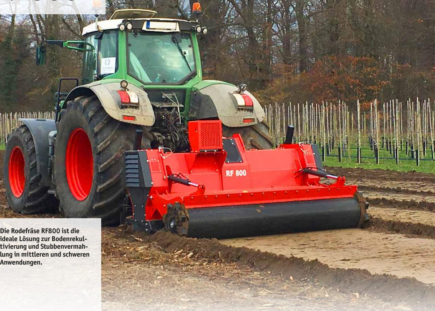
Die Rodefräse RF800 ist die ideale Lösung zur Bodenrekultivierung und Stubbenvermahlung in mittleren und schweren Anwendungen.
