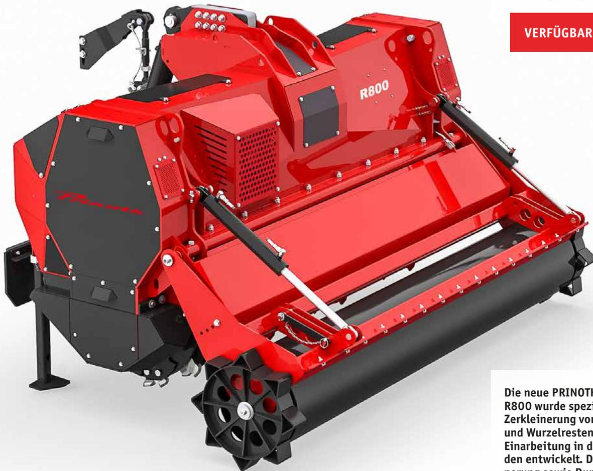
Die neue PRINOTH Rodefräse R800 wurde speziell für die Zerkleinerung von Wurzeln und Wurzelresten sowie deren Einarbeitung in den Unterboden entwickelt. Die Zerkleinerung sowie Durchmischung der Biomasse findet in einem Arbeitsgang statt.
