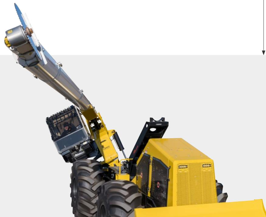
Grâce à la conception unique de la tête de scie, l'utilisateur peut effectuer des coupes difficiles de manière rapide et contrôlée. La lame de scie peut être tournée de 180° – en combinaison avec l'inclinaison latérale de la cabine, cela permet de travailler avec précision dans toutes les positions.
