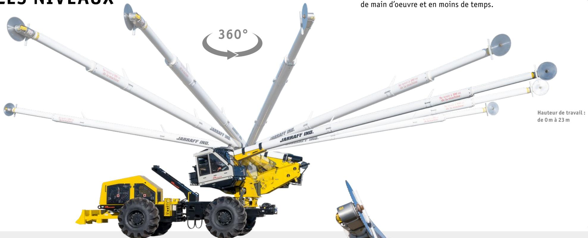
Avec son long bras et sa lame de scie inclinable à 180° à l'extrémité, le bras télescopique peut atteindre et couper sans effort des branches d'un diamètre maximal de 20 cm jusqu'à 23 m de hauteur. La flèche repose sur une couronne de rotation orientable à 360°, qui peut en outre être inclinée latéralement jusqu'à 40° des deux côtés pendant le fonctionnement, afin de s'adapter de manière optimale aux irrégularités du terrain.
