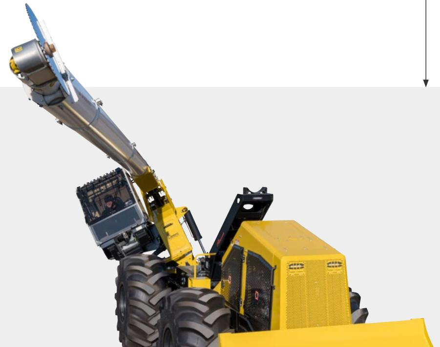
Gracias al diseño único de la cabeza de corte, el usuario puede realizar cortes difíciles de manera rápida y controlada. La cabeza de corte se puede girar 180°, lo que, en combinación con la inclinación lateral de la cabina, permite un trabajo preciso en todas las posiciones.
